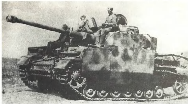
Немецкий танк Т-IV к 1943 г. получил дополнительное бронирование, бортовые экраны, мощную пушку и часто принимался нашими солдатами за «Тигр»
