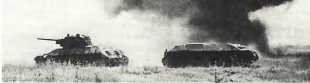
Эвакуация с поля боя подбитого Т-34 инженерным танком (Т-34 без башни)
