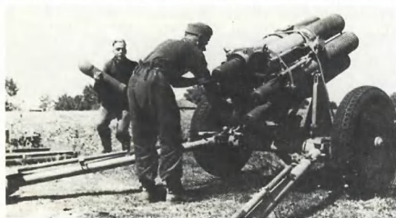
Немецкий аналог "катюши" – 150-мм "химический" миномет ("вабюша")
