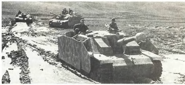
Усиленное бронирование германской бронетехники, проведенное накануне Курской битвы, привело к тому, что проходимость немецких танков и штурмовых орудий ухудшилась. После дождей, прошедших в районе Прохоровки накануне сражения, немцам пришлось действовать на более узких участках. Вот и болотистая местность вдоль реки Псел «загнала» их на «танковое поле».
